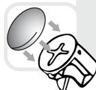
Al finalizar el ajuste de los conectores, proceda a poner las tapas adhesivas /
