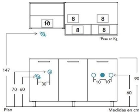
○ Punto Hidráulico ● Desagüe ↻ Punto Eléctrico 110 V ⊕ Punto de Gas
