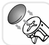
Al finalizar el ajuste de los conectores, proceda a poner las tapas adhesivas. /
