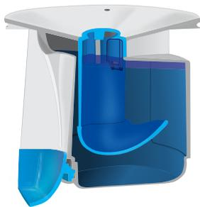
**1.** El cartucho está lleno de líquido con una capa de gel sellador biodegradable que flota en la superficie.
