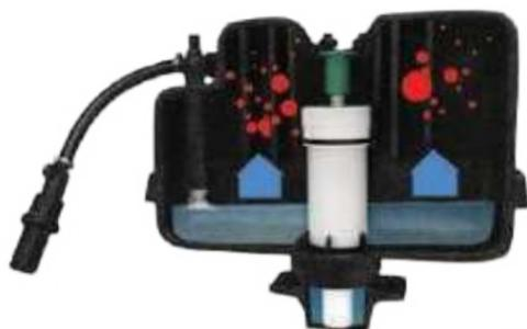
Se reinicia el ciclo de llenado (30 segundos). El aire contenido en el interior de la válvula principal acciona el mecanismo de cierre.
