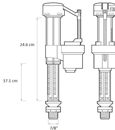
Esta valvula puede tener una altura ajustable entre 171 mm y 246 mm, ideal para tanques bajos.
