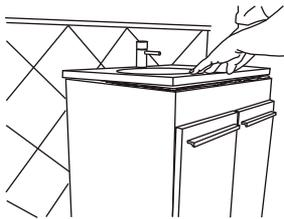
Ubique el lavamanos con mesón en posición de instalación y asegúrese que haga buen contacto con el cordón de silicona aplicado.
