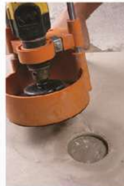
Figura 8-6: Brocas diamantadas y guía de Foragrés®.
