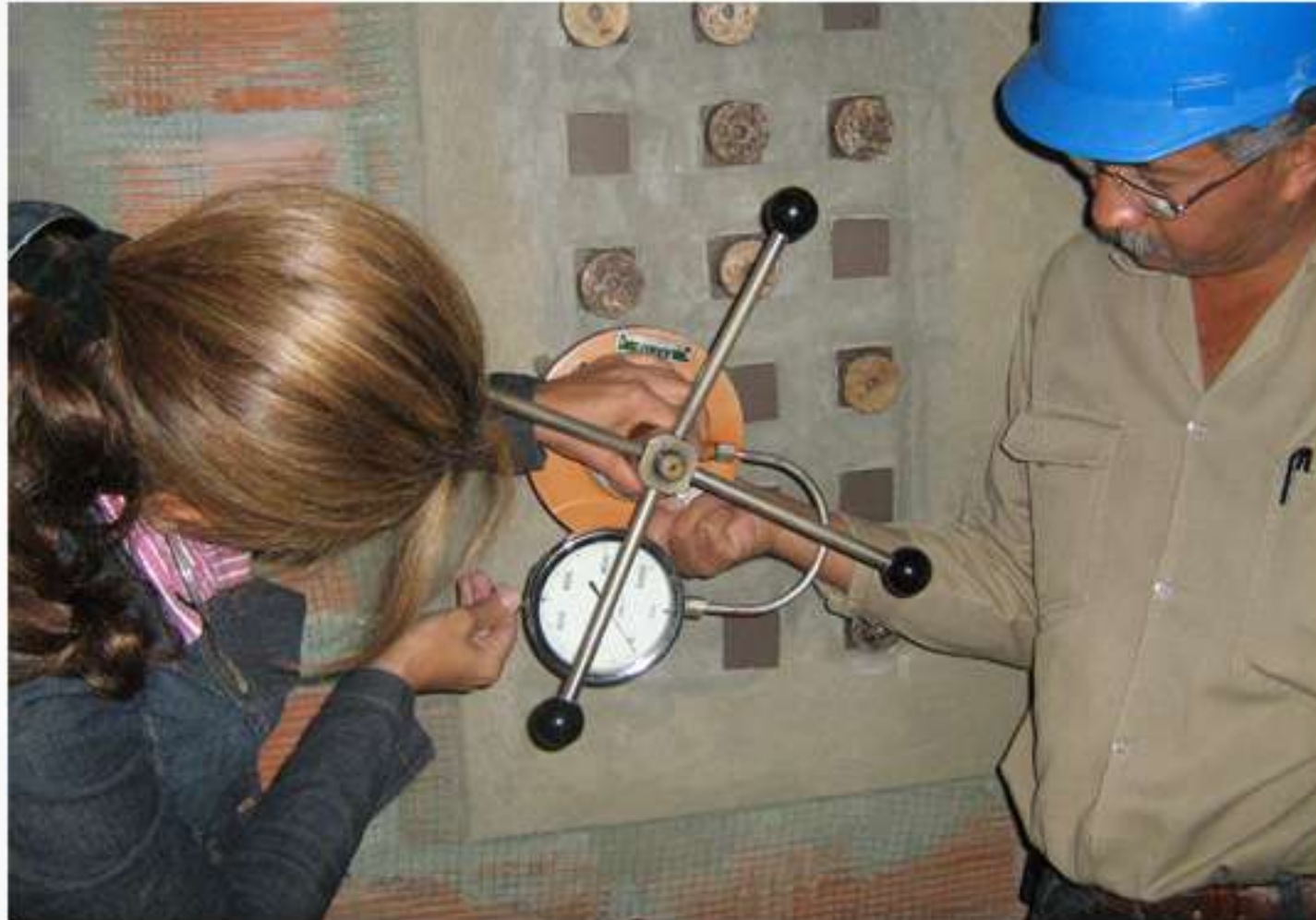
Figura 8-21: Ensayo de adherencia del sistema de revestimiento.
